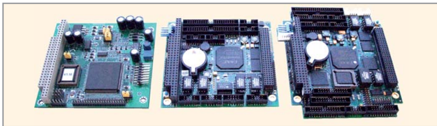
Рис. 1. Модуль PC/104 и PC/104-plus с «крыльями» и без «крыльев»
