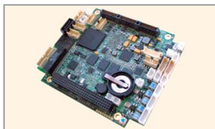
Рис. 4. Модуль StackPC типа CPC350, адаптированный под формат PCIe/104 (Фаствел, Россия)
